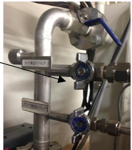
サイドボックス圧力が-0.1になったら、バルブを全開にして確実に真空にします。
