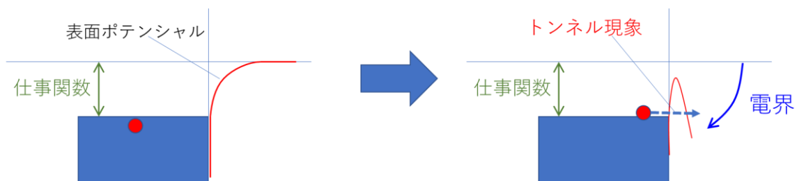
図 15 電界放射がおこるメカニズム。
